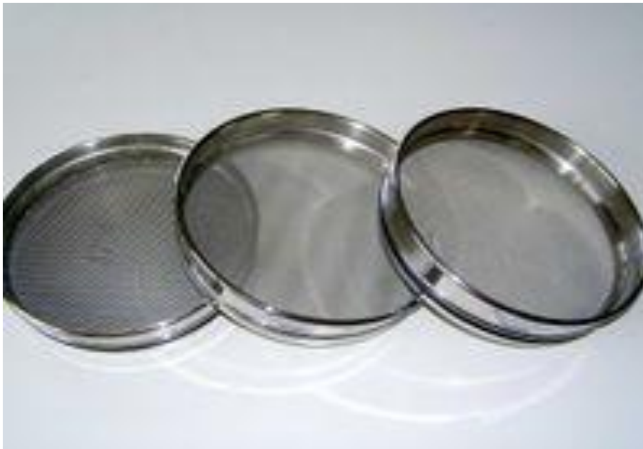
Рисунок 7. Сито с диаметрами решёток 0,2 мм
