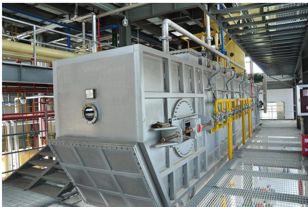
Рисунок 4. Промышленный экстрактор установленный на экстракционном цехе.
