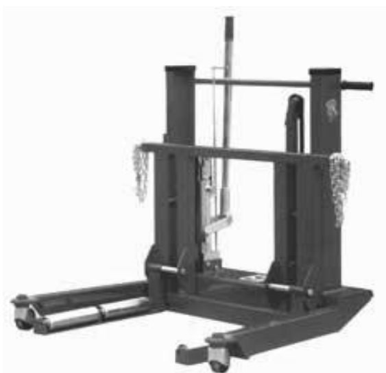
6.23-rasm. Avtomobillar g'ildiraklarini yechib olish, o'rnatish va transportirovkalash uchun aravacha. a. umumiy ko'rinishi, b. ish jarayonida.
