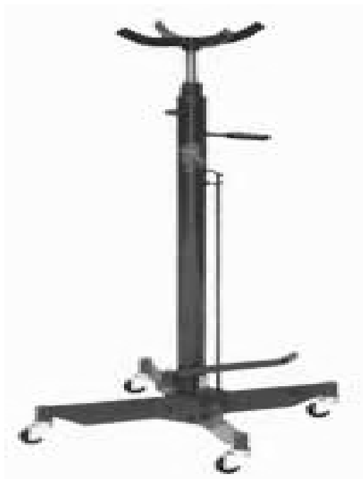
6.13a-rasm. Transmissiya agregatlari uchun xarakatlanuvchi ustun (rusumi-KE-32, yuk ko'tarish qobiliyati 600 kg, ko'tarib olish balandligi 1125 mm, ko'tarish balandligi 1950 mm, tashqi o'lchamlari 375x305x112 mm, massasi 49 kg).
