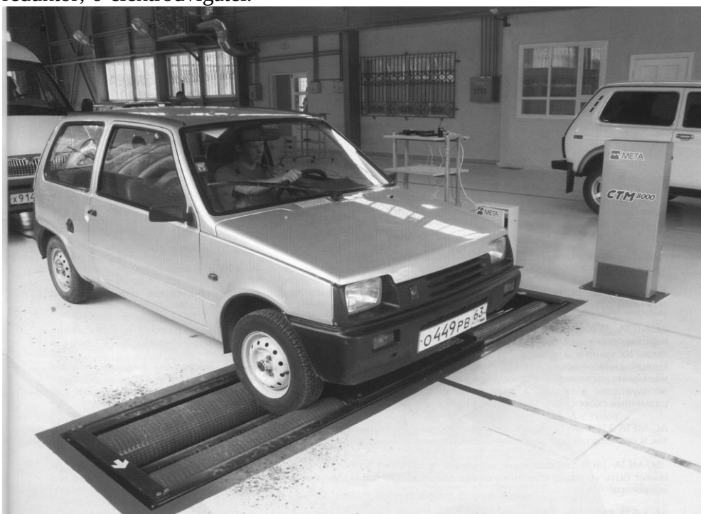
6.25-rasm. Kuchlar orqali ishlovchi rolikli stendning umumiy ko'rinishi (a) va kinematik sxemasi (b) : 1-maxovik; 2-jixoz barabanlari; 3-zanjirli uzatma; 4-elektromagnitli mufta; 5-reduktor; 6-elektrodvigatel.
