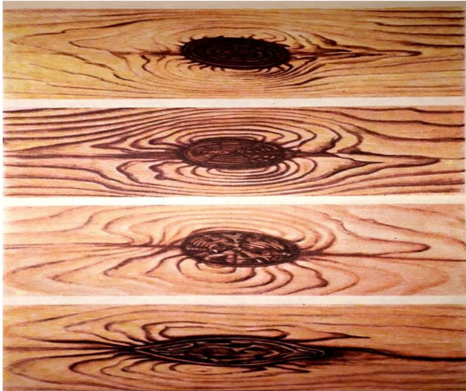
2.10-rasm. Yog'och materiallar ko'ndalang kesim yuzasida ayrim turdagi ko'zlarning joylashuvi:
