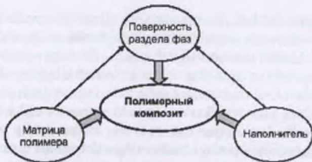
8.1-rasm. Polimer kompozitsion material hosil bo'lishini tushuntiruvchi sxema. (Mikitaev A.K. va boshqalar. Materialovedeniye (Materialshunoslik) 2009. № 1 ).
