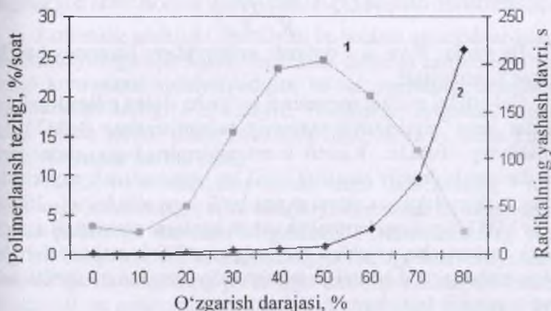
3.1.1-rasm. O'zgarish darajasining metilmetakrilat polimerlanish tezligiga ta'siri (1) va 22,5°C da radikalning yashash vaqti (2) (Oudian J. Osnovi ximii polimerov. M.: Mir. 1974. 614 s. kitobidan olindi. )
